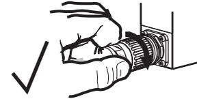
3. Faire tourner l'écrou d'accouplement en sens horaire pour maintenir le connecteur en position jusqu'à ce que le connecteur de câble ne bouge plus.
