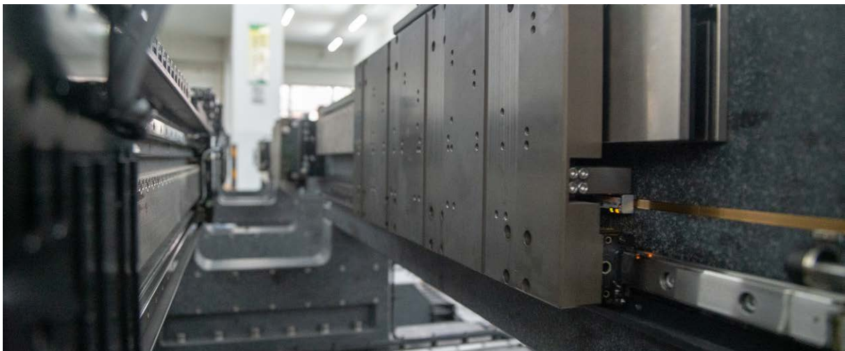
Renishaw RGSZ20S: una regla que se expande o se contrae con el sustrato
