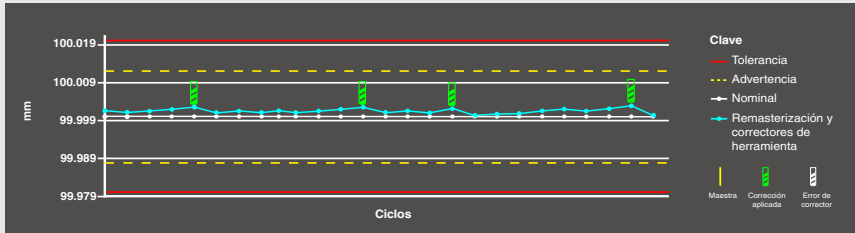
Gráfico de Process Monitor mostrando correcciones enviadas al CNC
