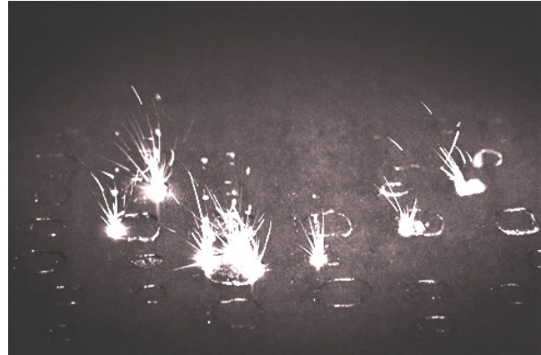
Fusión láser durante el proceso de construcción
