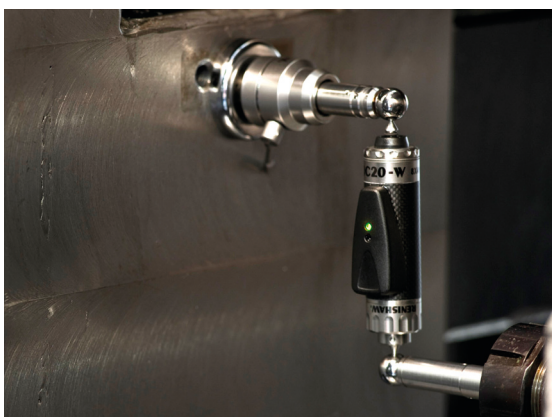
Bezdrátový ballbar QC20-W na obráběcím centru ve společnosti Spirax Sarco
